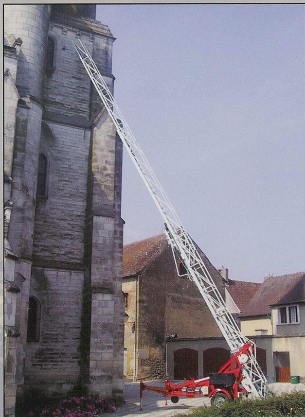
Possibilité d'être déplacée, échelle dressée, repleyée en la faisant rouler sur ses trois roues
